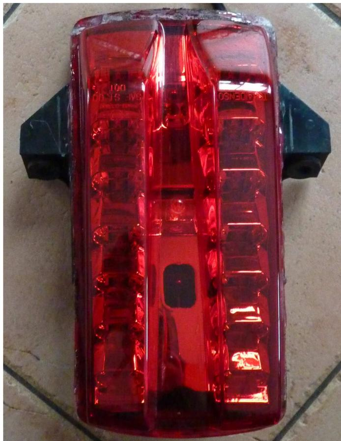
Nun ist an den Seiten des Rücklichtes eine Fuge zu sehen. Mit dem Dremel wird nun vorsichtig in der Fuge an der Unterseite (also zum Unterteil hin) die rote Kappe durchgeschnitten. Damit sollte man in aller Ruhe vorgehen. Durch das Schneiden entsteht
