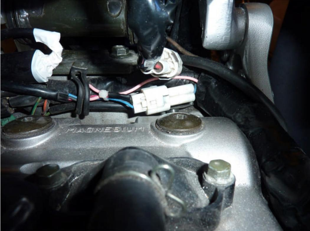
Die neuere Version der Ganganzeige hat nun auf Grund der Verfügbarkeit der originalen Steckverbinder des Gangsensors einen Zwischenadapter, der jegliche Nachklemmerei am Anschluss des Gangsensors vermeidet. Einfach zwischenstecken - plug&play also.
