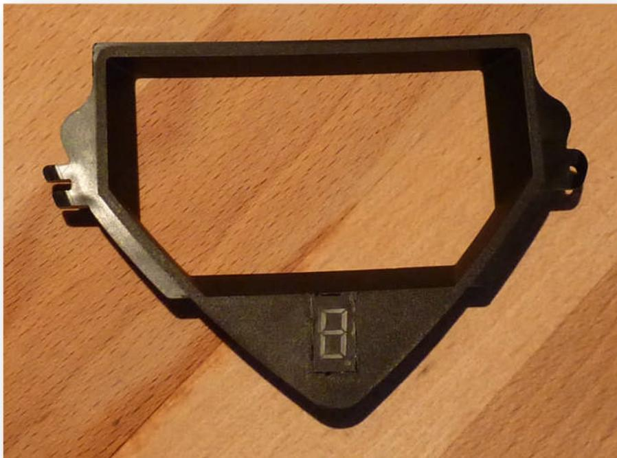
2.6. Einbau der Platine mittels der vorgesehenen Klebe-Pads. Die Platine passt genau zwischen die Abstandsnippel. Einfach einlegen und andrücken. Die rosa Leitung durch das zuvor gebohrte Loch in der Unterschale nach außen führen. Dabei darauf achten, dass kein Zug an der Leitung entstehen kann. Abschließend die Leitung am Durchführungsloch mittels eines kleinen Kleckses Heißklebers flach fixieren.
