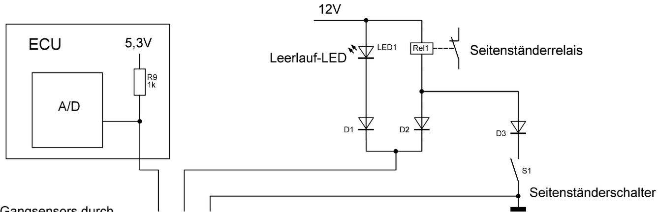
Fremdspeisung der Gangsensors durch die Ganganzeige.
